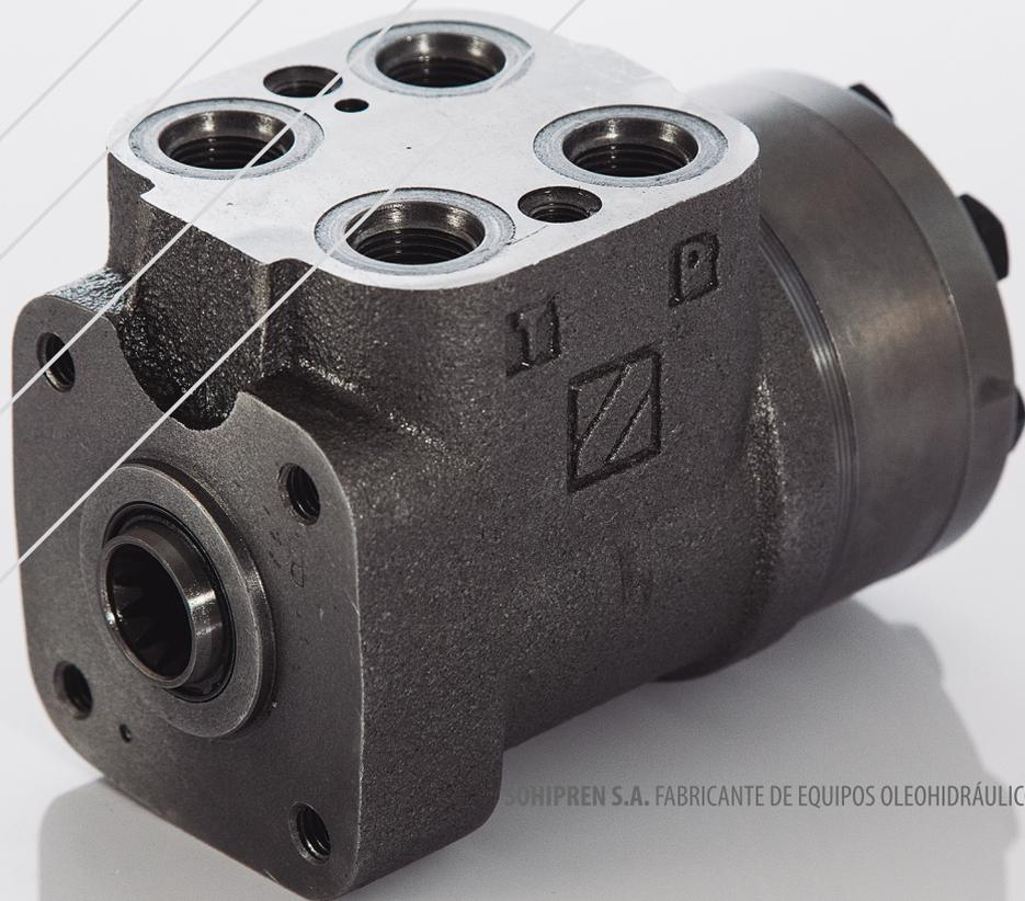
Los modelos DLCc poseen válvula de alivio, válvula de impacto, válvula de aspiración y válvula de retención de entrada incorporadas.
